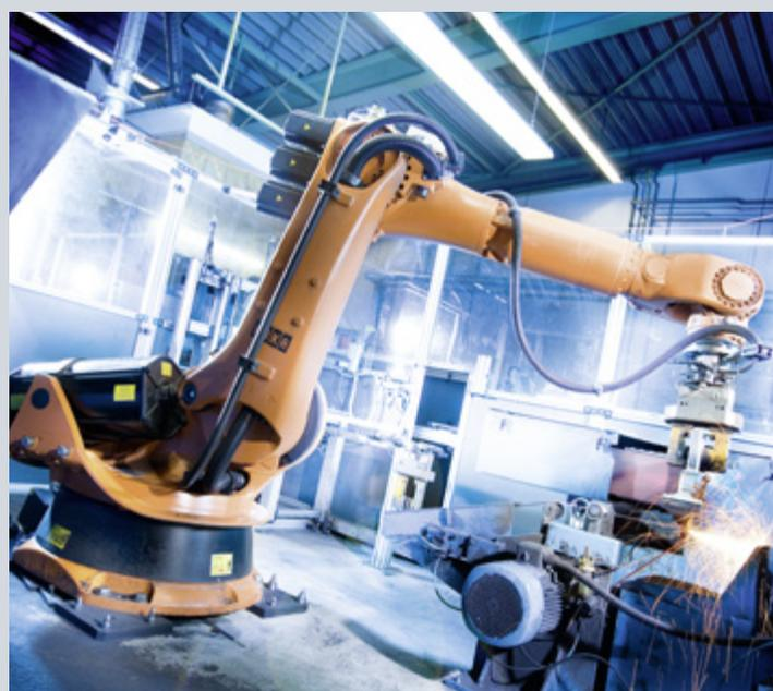
Робот для шлифования и регулировки твердости
