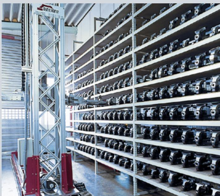
Автоматизированный промезуточный склад и распределительный центр
